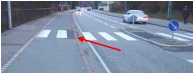
Mynd 4: Har tað er neyðugt, eru oyggjarnar partur av gonguteigi. Miðrásin er sjálvandi so mikið breið, at til ber hjá teimum, ið eru til gongu, at steðga á mitt á vegnum og bíða, til eingin bilur er á hinari veghálvuni. Tað sæst, at skorið er niður í súkklubreytina (kundi eisini verið í gongubreytina), so at tað verður ein mjáur skrái niður á vegin, og tað tí er høgligari hjá fólki við barnavogni, í rullustóli og hjá teimum, ið annars eru til gongu.
